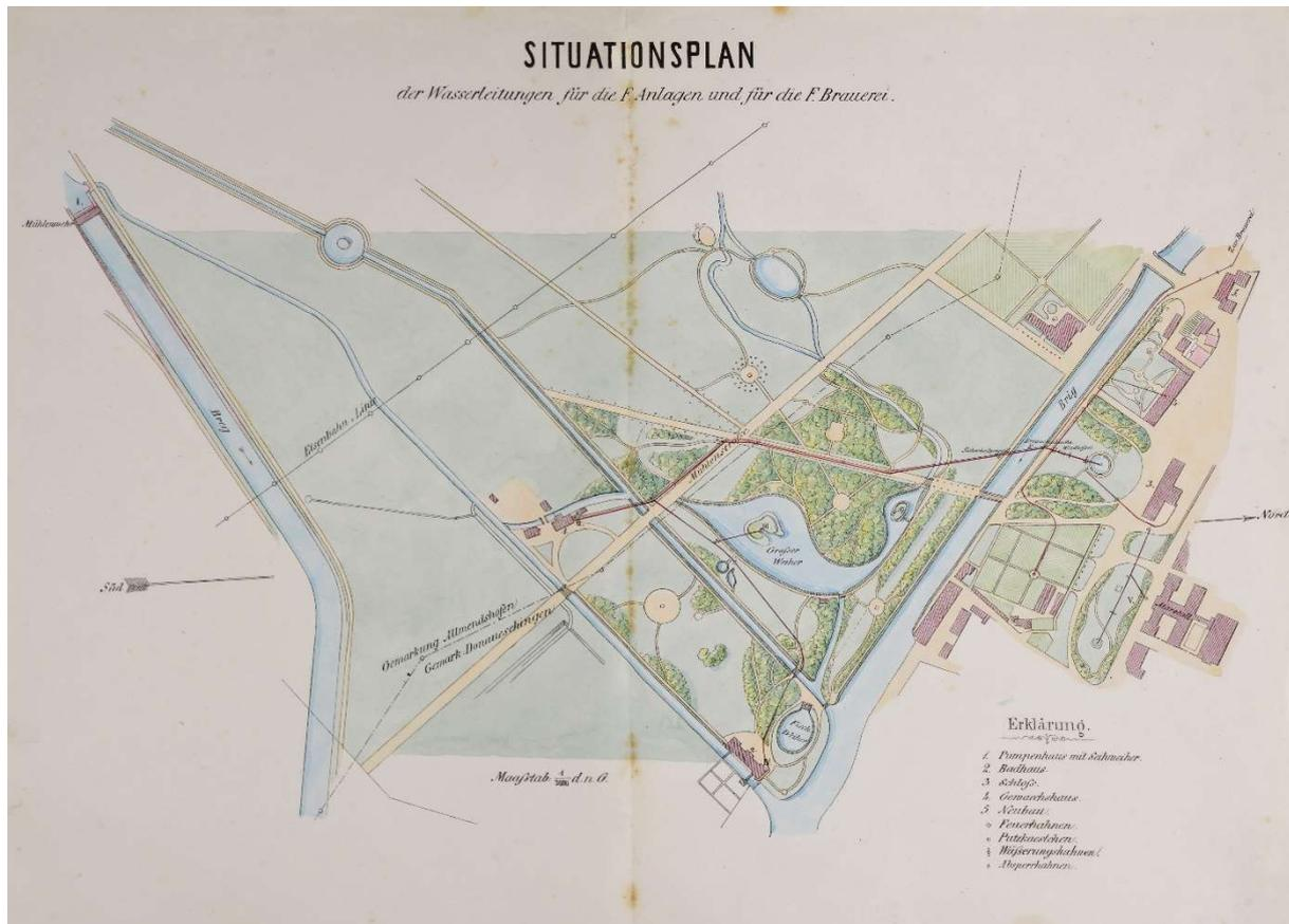
Lageplan der Wasserleitungen im Schlosspark, ohne Jahr [um 1890]. Rechts neben dem Mühlgebäude, unmittelbar über der rot eingetragenen Wasserleitung das heute verschwundene Filterierbecken für das Bregwasser. Vorlage: FFA, Karten.
